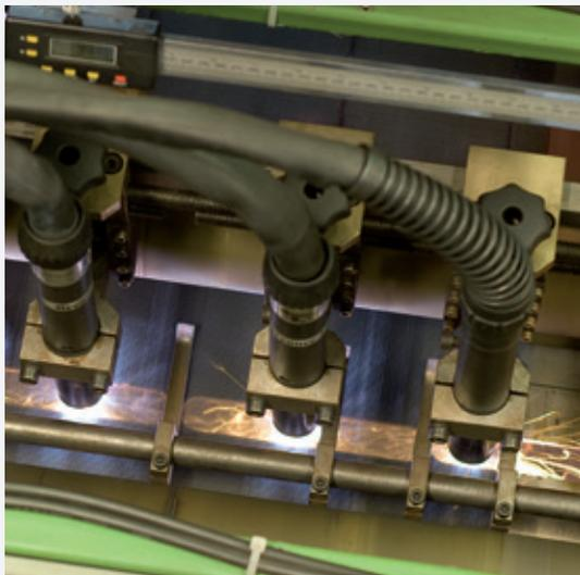
Plasmaverschweißte Ränder gewährleisten einen kontinuierlichen, störungsfreien Durchzug der Filterbänder
